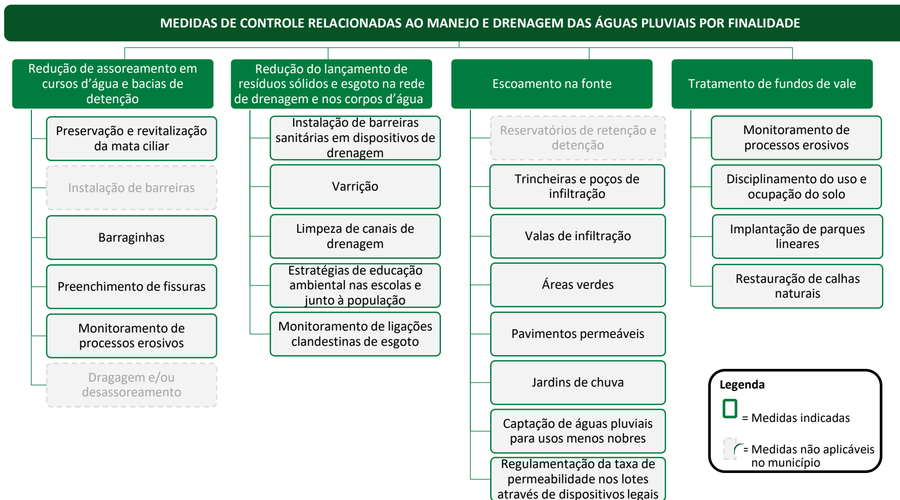
Figura 4.3.4 – Fluxograma das medidas de controle relacionadas ao manejo das águas pluviais por finalidade de Esperança/PB
