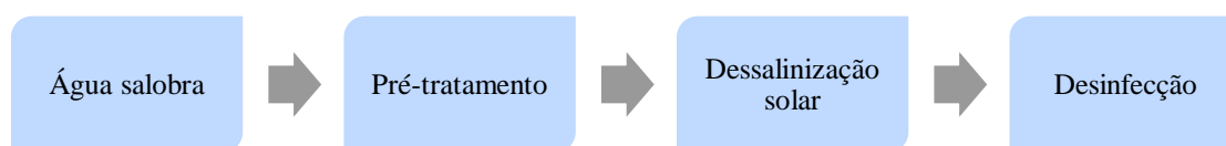
Figura 4.1.10 – Esquema de dessalinização solar para utilização em sistemas alternativos
