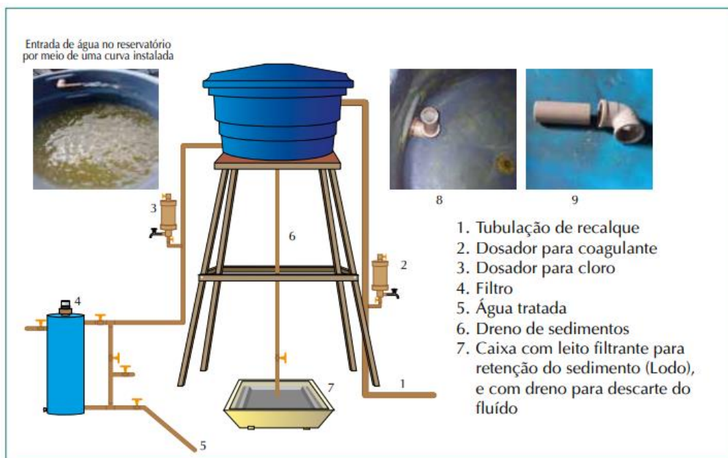
Figura 4.1.8 – Solução Alternativa de Tratamento de Água (SALTA-Z)
