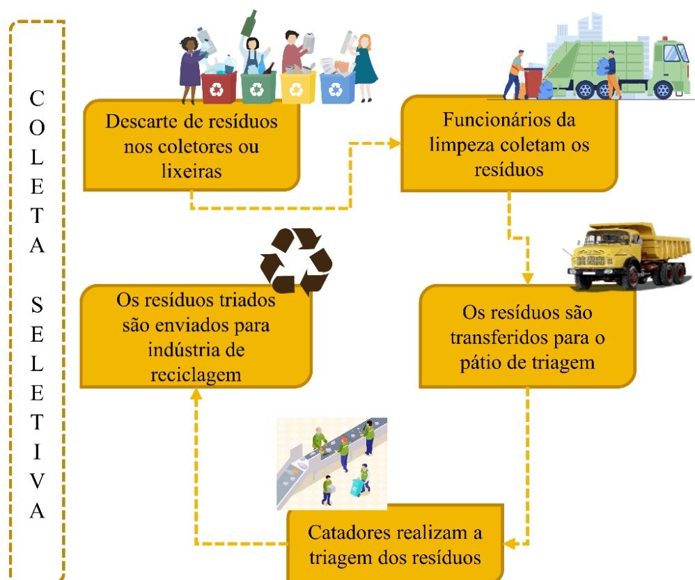
Figura 4.4.14 - Fluxograma da coleta convencional e da coleta seletiva
